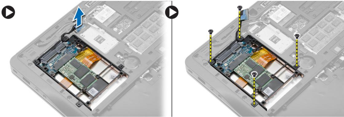
4. Levante la canastilla de la unidad de disco duro del equipo.
