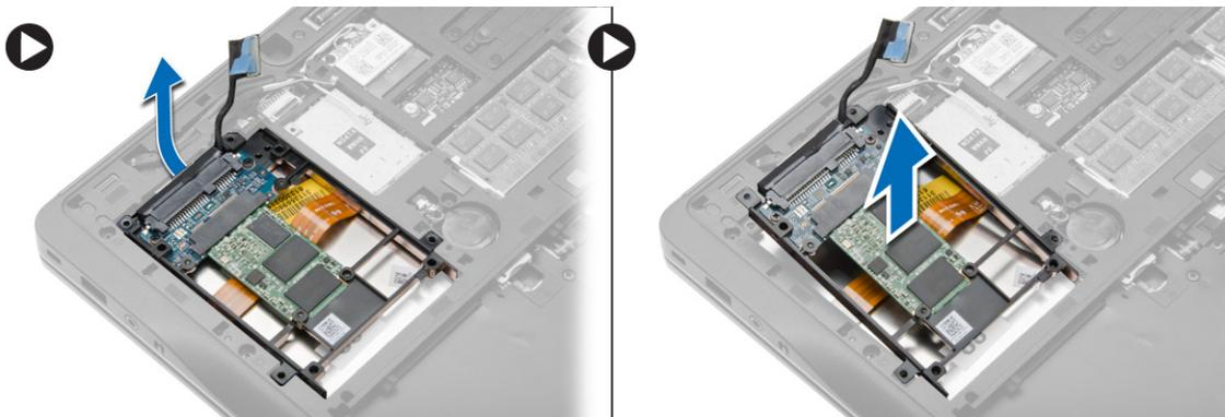
5. Desconecte el cable de la unidad de disco duro que fija la unidad de disco duro a la canastilla para unidades de disco duro.
