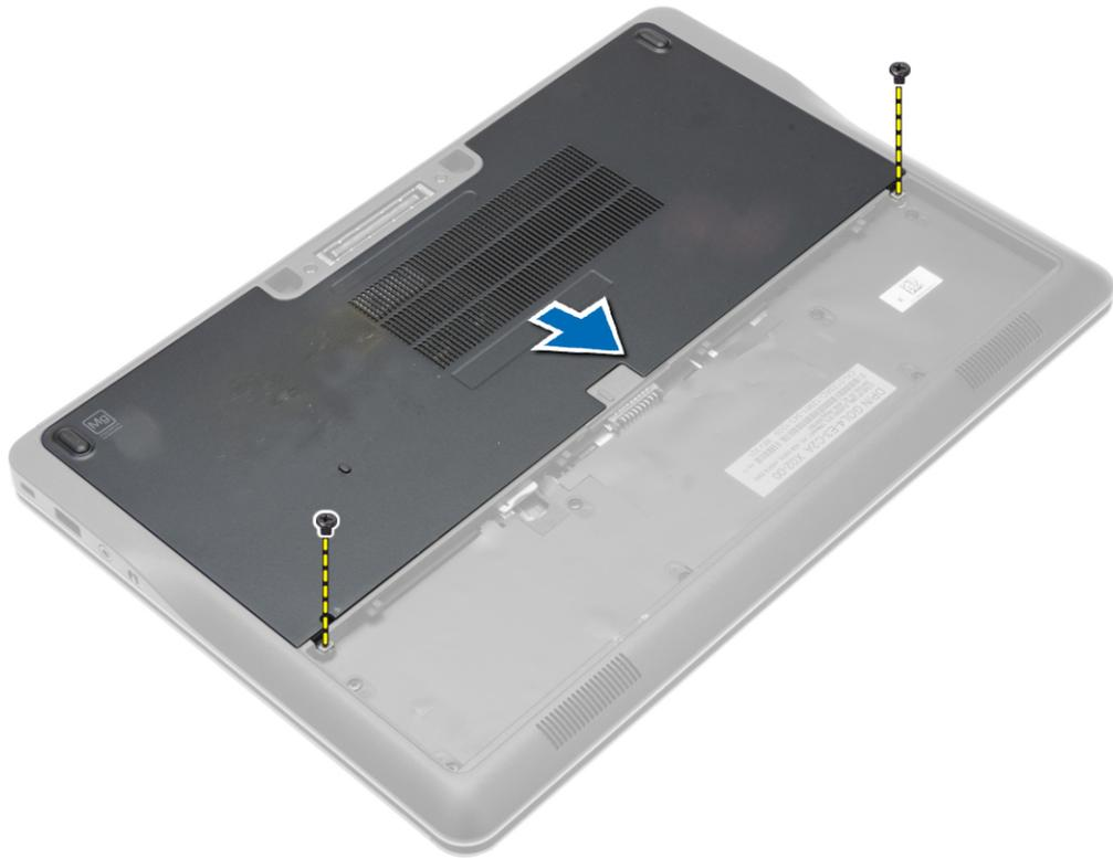
4. Levante la cubierta de la base y extráigala del equipo.
